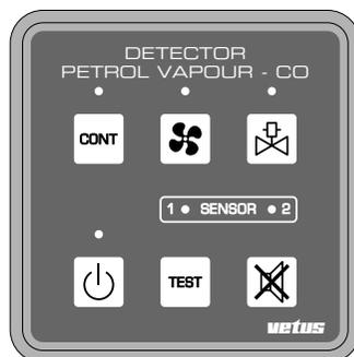
**Il sensore impiega circa 1 minuto a riscaldarsi, dopodichè inizia a rilevare in maniera affidabile l'eventuale presenza di gas. Durante il riscaldamento del sensore il sistema effettua un controllo del collegamento e del corretto funzionamento dello stesso.**
