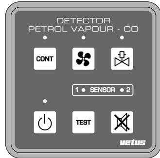
**El sensor se habrá calentado al cabo de aproximadamente 1 minuto y el detector ya podrá detectar la presencia de gases con fiabilidad. Cuando el sensor se está calentando se realiza una prueba de funcionamiento para determinar si el sensor está conectado y si funciona correctamente.**
